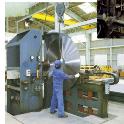
油圧式歪調整膨張調整機
